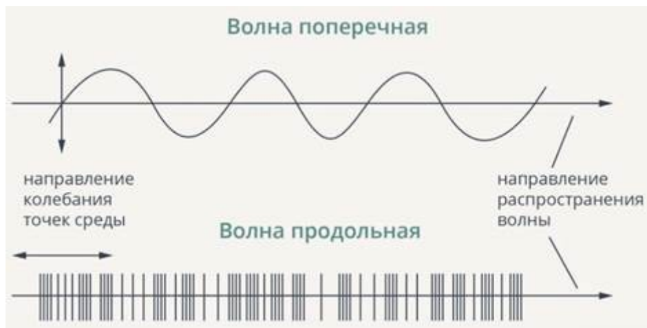
Рис. Поперечные и продольные волны
